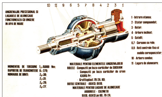
Figura 17. Modul electromecanic precesional 2K-H (nonpoluant) pentru Complexul Robotizat
